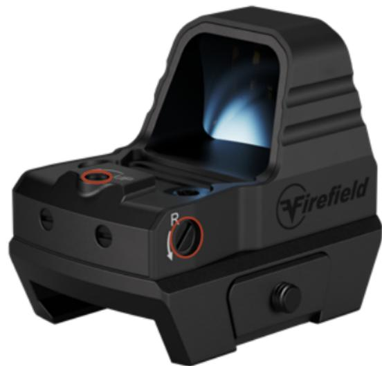
Das Ironclad Mini Reflex Sight ist sowohl mit Höhen- als auch mit Seitenverstellung ausgestattet. Es handelt sich um stufenlose Einstellungen, die keine Klicks haben. Bei der Nulleinstellung ist es am besten, den Punkt zunächst mit einer Sekundäroptik oder einem Laserzielgerät auszurichten, bevor Sie die endgültigen Einstellungen vornehmen. Einstellen der Höhen- und Seitenverstellung:
