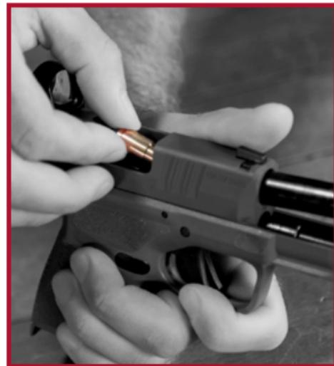
1. Sobald die Optik montiert ist, den Verschluss entfernen oder die Waffe auseinanderbauen, bis eine gerade Sichtlinie durch den Lauf vorhanden ist.
